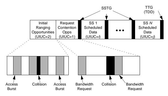
Figure 154—Uplink subframe structure
